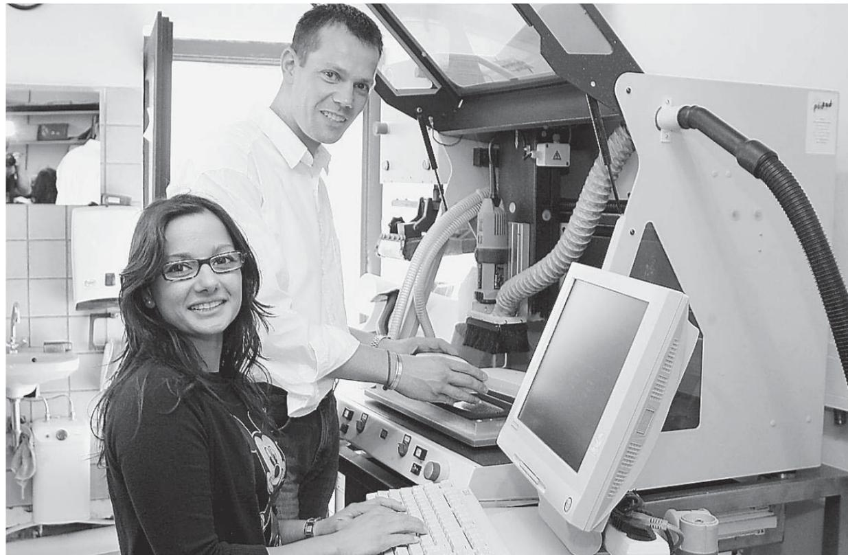
**Orthopäde Jörg Schmidt und seine Mitarbeiterin Tina Bertelt an der hochmodernen CNC Fräsmaschine, auf der Einlagen computergesteuert gefräst werden.**
