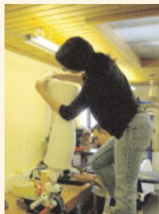
6 Die Glasgitterschläuche werden unter Vorspannung gebracht.
